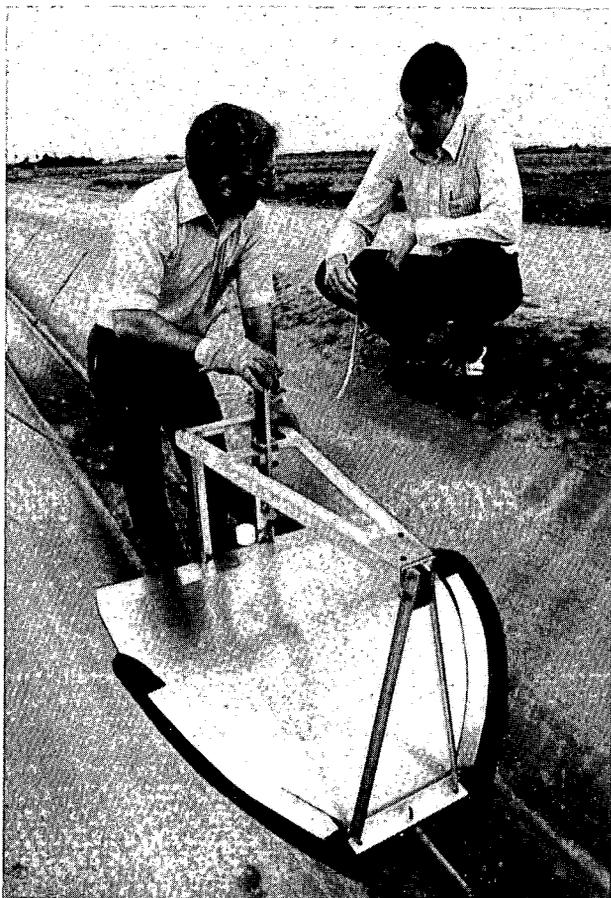
Figura 5.6 Vertedero portátil para uso en canales revestidos (Arizona).
