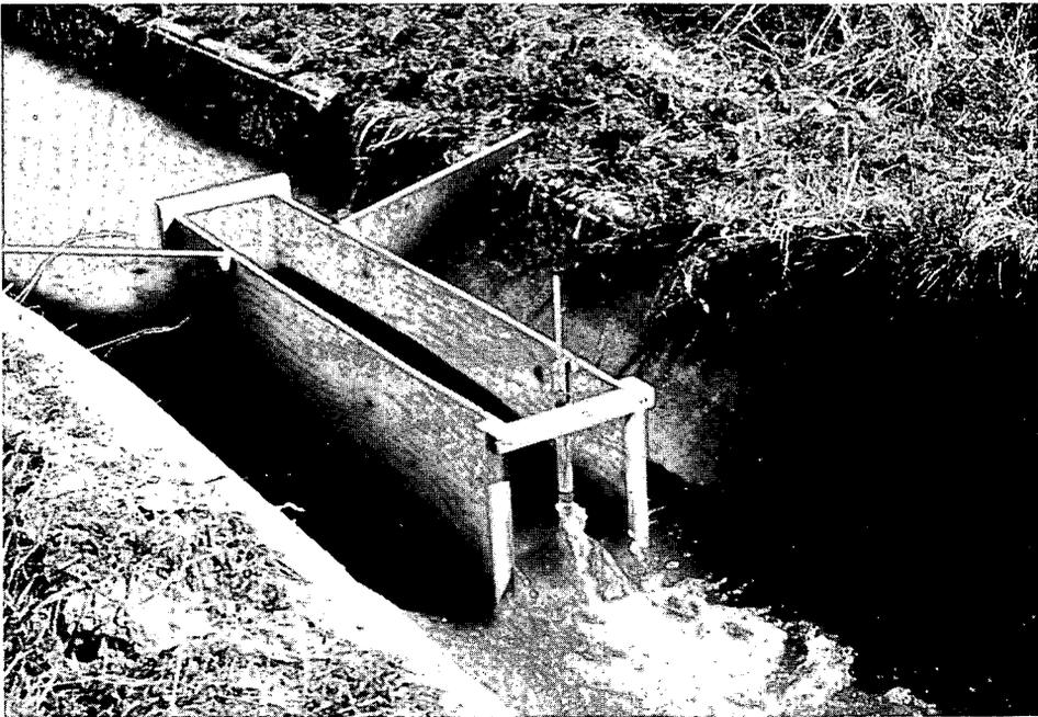
Figura 5.14 Para medir la altura de carga puede utilizarse un limnómetro de aguja.
